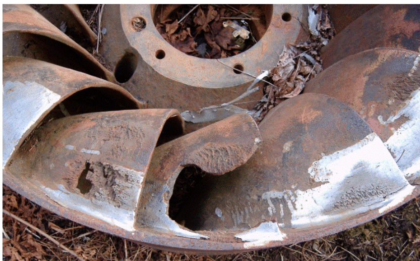
Figura 8 - Efeitos da cavitação em um rotor de turbina Francis
