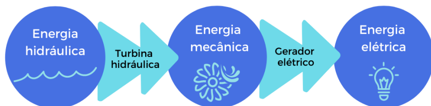
Figura 3 - Conversões de energia a partir da energia hidráulica
