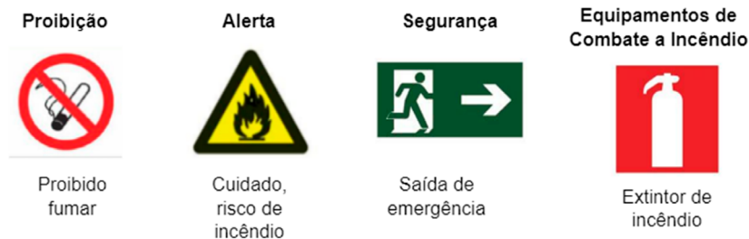
Figura 20 – Aplicações das cores nas sinalizações de segurança
